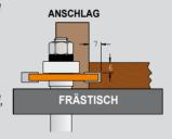
Schritt 5: Um in die Türe die Nut für die Feder zu fräsen kann der Anschlag weiterhin in der 7mm Position belassen werden. Den Schlitzfräser auf 6mm Frästiefe von der Stirnseite der Tür einstellen und wie abgebildet nuten.
