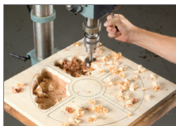
Passate l'interno del vassoio con una punta Forstner da 50,8mm in un trapano a colonna.
