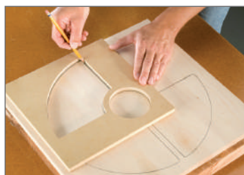
Tracciate la forma all'interno della dima.
